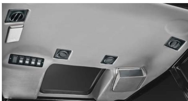
Příprava pro rádio, klimatizace a střešní průzor.
